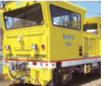
モーターカー「105D号車」 ダンプトロリなどを牽引し、レールや砕石を運搬します。
