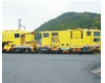
バラストフィニッシャー「802B号車」 マルチプルタイタンパー作業後の軌道整備時に活躍します。
