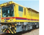
レール削正車「RG301」 レール頭部の形状を適切に保つため、レール頭部を削る作業車です。
